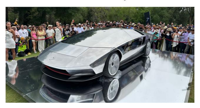
La Peralta S, sportiva a motore centrale e trazione posteriore, è un'auto futuristica interamente realizzata a mano, in alluminio completamente a vista e lucidato a specchio, con la particolarità che non vi sono differenze visive tra le superfici vetrate e la carrozzeria, creando un effetto monolito.
